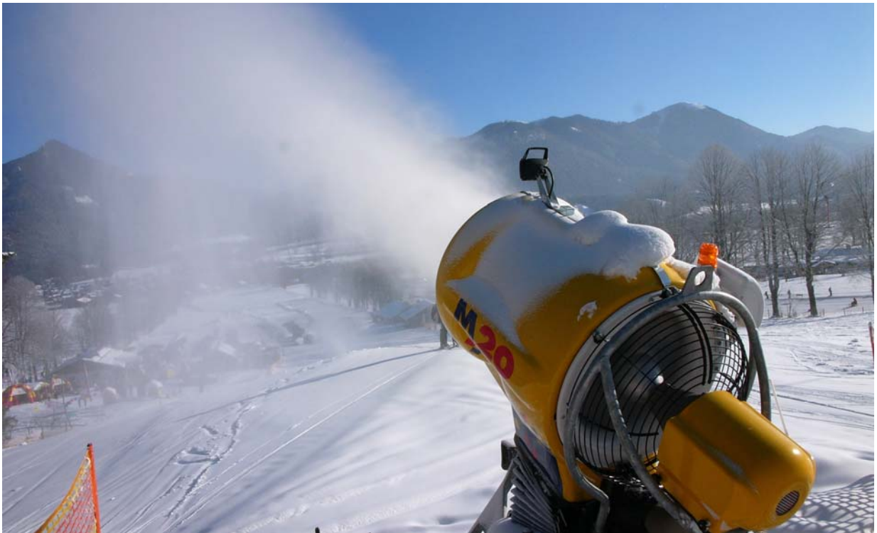
Technische Beschneigung mit einer Propeller-Maschine.
