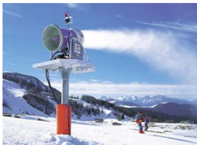
Abb. 1 bis 3: Niederdrucksystem fix auf Masten und auf mobil auf Schlitten montiert
